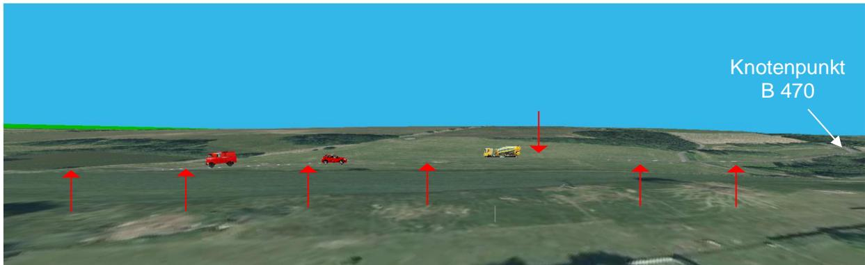
*Bild 20: Talraumvariante i. d. Panoramaansicht, Verlauf am gegenüberliegenden Hang optisch einsehbar (Blick aus dem 2. Obergeschoss, Bereich Lindenstraße, Screenshot aus Lärmmodell) rote Pfeile markieren den Straßenverlauf*
