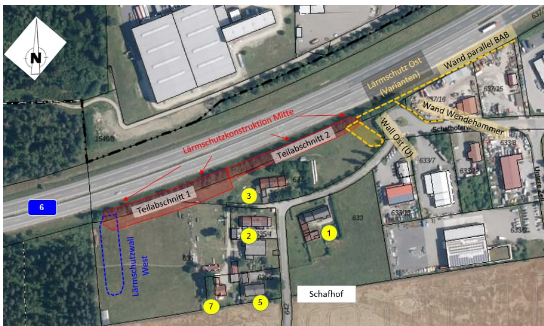
Bild 3: Grundbausteine der Lärmschutzvarianten
