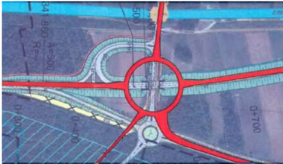
Abbildung 9: große Kreisverkehrslösung für Anschlussstelle „Mühlhausen-Nord“
