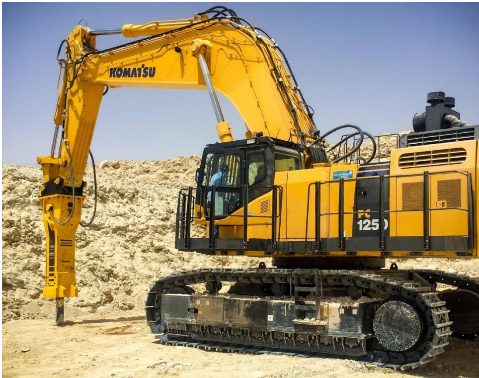
Abbildung 2.1: Bagger mit Meißelaufsatz (Hydraulikhammer)
